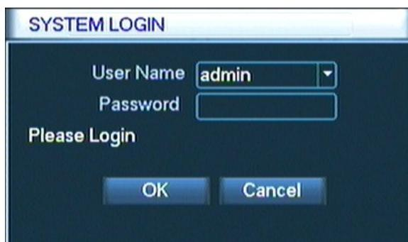
**Protezione con password**: se si inserisce la password in modo errato per tre volte consecutive l'allarme si avvia. Se si inserisce la password in modo errato per cinque volte consecutive l'account verrà bloccato.
