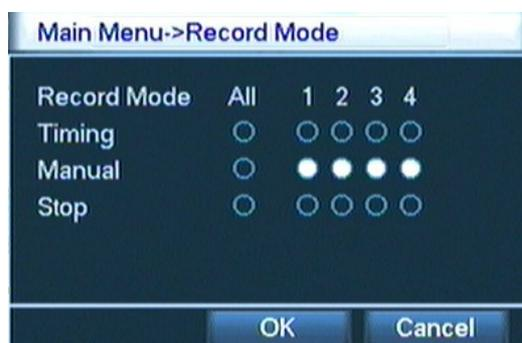
Figura 3.3 Interfaccia controllo registrazione
