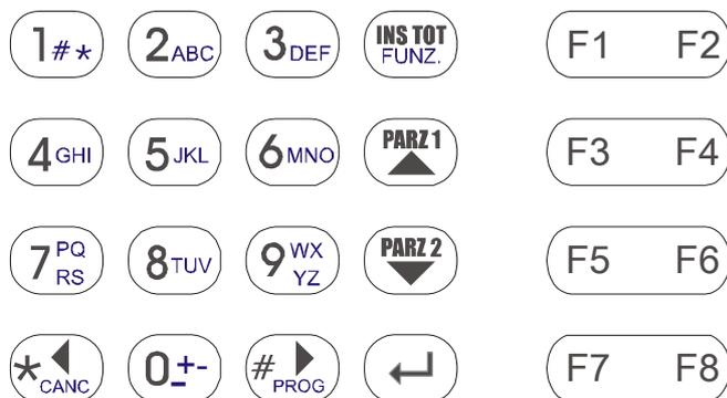
I tasti numerici ( da 0 a 9 ) vengono usati per digitare i codici di accesso, necessari per entrare in programmazione ( tecnico o utente ) o per inserire / disinserire.
